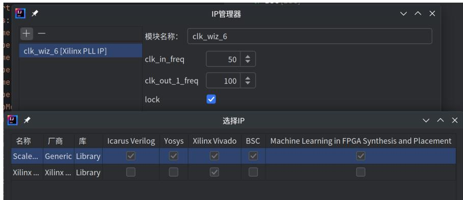
图 2-11 使用 Scaleda IP 核管理器添加 IP 核
